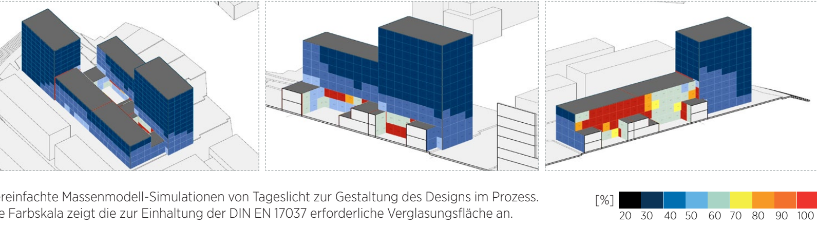
Vereinfachte Massenmodell-Simulationen von Tageslicht zur Gestaltung des Designs im Prozess. Die Farbskala zeigt die zur Einhaltung der DIN EN 17037 erforderliche Vergrößerungsfläche an.
